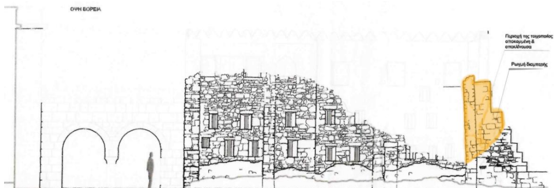
Εικ. 2: Σχεδιαστική απεικόνιση του προς αποσυναρμολόγηση και ανάταξη τμήματος της τοιχοποιίας της μεγάλης οχύρωσης επί της οδού Ιπποκράτους, που εμφανίζεται με χρώμα (Εργασίες Α2 και Α3).
